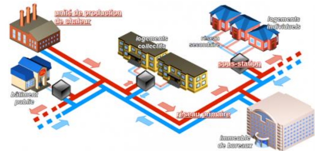
Figure 166 : Principe de fonctionnement d'un réseau de chaleur
